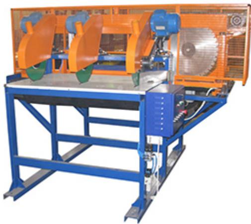
Установка продольной и поперечной резки базальтового полотна (мата) серии УППР предназначена для обрезки кромки и разрезания базальтового полотна на плиты шириной 500 мм, 850 мм или 1000мм и длиной до 1500 мм.
