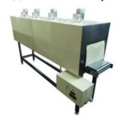
Термоусадочная камера МТУ-147 с четырьмя зонами обдува предназначена для штучной и групповой упаковки длинномеров, дверей, мебельных щитов в полиэтиленовую термоусадочную пленку. Тип и характеристики упаковочного материала подбираются в каждом конкретном случае с учетом назначения упаковки, вида, размеров и количества продукции.
