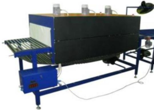
Упаковочный термотоннель МТУ-131 представляет собой сборную металлическую конструкцию, состоящую из рабочей камеры, вентиляторов обдува рабочей камеры, транспортёра, узла охлаждения готовой продукции и блока управления, закрепленного на основании транспортёра термотоннеля.
