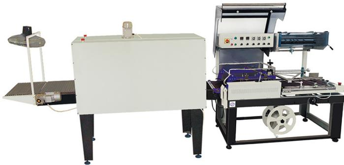
Упаковочная машина МТУ «ТРИНИТИ АВТОМАТ» предназначена для штучной и групповой упаковки различных видов продукции в поливинилхлоридную (ПВХ) и полиолефиновую термоусадочную пленку (полурукав), в автоматическом режиме.
