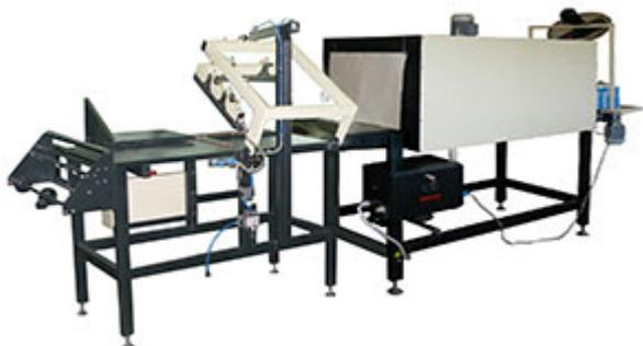
Упаковочная машина МТУ «ТРИНИТИ» предназначена для штучной и групповой упаковки различных видов продукции в поливинилхлоридную (ПВХ) и полиолефиновую термоусадочную пленку (полурукав), в полуавтоматическом режиме.
