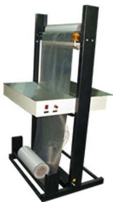
Термонож МТУ-221 предназначен для сварки и отрезки термоусадочной полиэтиленовой пленки в процессе предварительной упаковки различных видов изделий. Термонож имеет электромагнитный фиксатор в положении сварки. Привод ножа и продвижение пленки осуществляется вручную.
