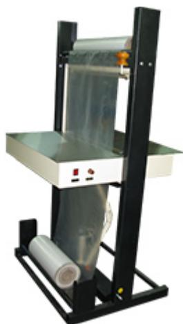
Термонож МТУ-221 предназначен для сварки и отрезки термоусадочной полиэтиленовой пленки в процессе предварительной упаковки различных видов изделий. Термонож имеет электромагнитный фиксатор в положении сварки. Привод ножа и продвижение пленки осуществляется вручную.
