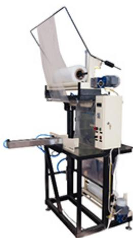
Термонож МТУ-262 предназначен для сварки и отрезки термоусадочной полиэтиленовой пленки в процессе предварительной упаковки различных видов изделий. Имеет пневматический привод ножа и формирователя упаковки, а также устройство автоматической подмотки пленки.
