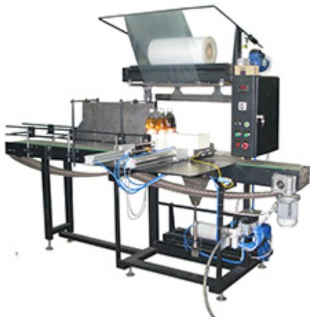
Термонож МТУ-263 предназначен для сварки и отрезки термоусадочной полиэтиленовой пленки в процессе предварительной упаковки различных видов изделий. Имеет пневматический привод ножа, формирователя упаковки и группиратора, а также устройство автоматической подмотки пленки.
