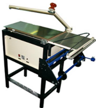
Термонож МТУ-251 предназначен для сварки и отрезки термоусадочной поливинилхлоридной (ПВХ) или полиолефиновой пленки в процессе предварительной упаковки различных видов изделий. Термонож, выполненный в виде угольника, имеет электромагнитный фиксатор в положении сварки.
