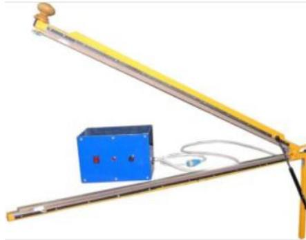
Оборачивающий узел МТУ-245 с прямым ручным импульсным термоножом (3 нити) применяется в составе упаковочного станка МТУ Стимул-850.
