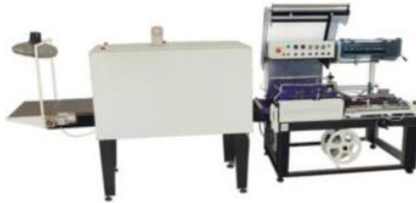
Автоматический упаковочный аппарат с обгонным термотоннелем МТУ Тринити-А предназначен для штучной и групповой упаковки различных видов продукции в поливинилхлоридную (ПВХ) и полиолефиновую термоусадочную пленку (полурукав) в режиме «Автомат».
