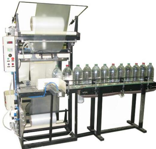
Упаковочная машина МТУ Оптима-600А предназначена для упаковки тары 5 и 3 литра, коробок, бутылок в лотке, топливных брикетов, бухт кабеля и др. попарно и по 4шт. и является переходной моделью между полуавтоматом МТУ Оптима-600 и автоматом МТУ Вектор-600.
