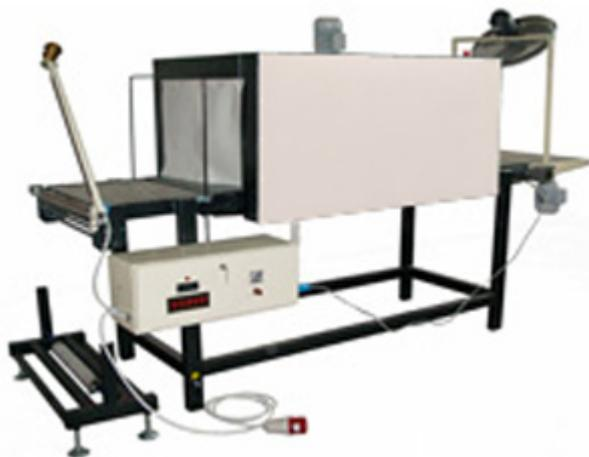
Термоупаковочная машина МТУ «СТИМУЛ-600» предназначена для штучной и групповой упаковки различных видов продукции в полиэтиленовую термоусадочную пленку. В состав машины входят: термотоннель МТУ-112 с движущимся транспортёром и одной зоной нагрева, оборачивающий узел с прямым ручным импульсным (три нити) термоножом МТУ-241, подающий и приемный ролик, напольный рулонодержатель. Возможна комплектация по
