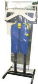
Установка для упаковки верхней одежды МТУ Силуэт предназначена для ручной упаковки одежды на вешалке (плечиках) в рукавную полиэтиленовую плёнку с последующей запайкой верхнего шва и формированием линии отрыва плёнки.
