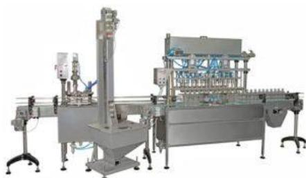
Линия предназначена для розлива уксуса и винных напитков в пластиковые бутылки объемом от 0,5 до 2,0 литров. Производительность автомата до 2500 бутылок в час. Дозирование продукта осуществляется по объему поршневым методом.
