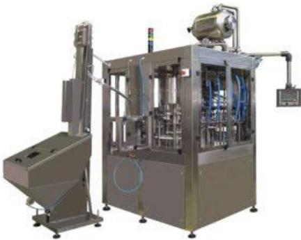
Линия розлива молока предназначена для розлива молока и кисломолочной продукции в пластиковую бутылку ПЭТ, нанесения на бутылку с продуктом самоклеющейся сегментной этикетки, простановки даты производства и получения упаковки из группы бутылок в термоусадочной полиэтиленовой пленке.
