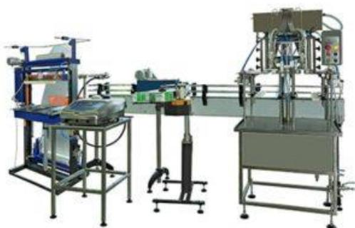
Линия розлива предназначена для розлива питьевой и газированной воды (в том числе с сиропом). Линия комплектуется моноблоком розлива серии РУ2П. Аппарат представляет собой моноблок-полуавтомат и совмещает в себе две рабочие операции: налив продукта и укупоривание наполненной бутылки.
