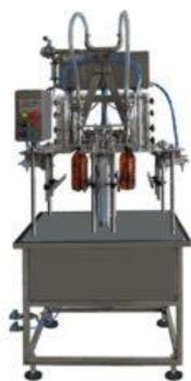
Линия розлива пива и кваса предназначена для розлива пенящихся продуктов в пластиковые бутылки. Производительность линии до 350 бутылок в час. Линия комплектуется полуавтоматом моноблоком розлива с изобарическим принципом налива. Диапазон разливаемой тары от 0,5 до 3,0 литров позволяет расширять ассортимент выпускаемой продукции.
