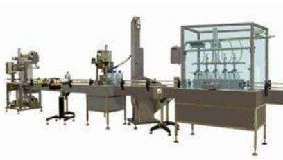
Линия розлива питьевой воды, предназначена для розлива воды в тару объемом от 3,0 до 10,0 л, комплектуется автоматом розлива серии АРЛ-5. Дозирование жидкости при розливе происходит по уровню. Максимальная производительность линии до 1500 бутылок в час.
