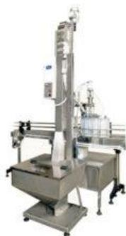
Укупорочное оборудование УА-3000-5 предназначено для автоматического укупоривания пластиковых бутылок емкостью от 3,0 до 10,0 литров. Автомат комплектуется ориентатором пробок OPT-3000.
