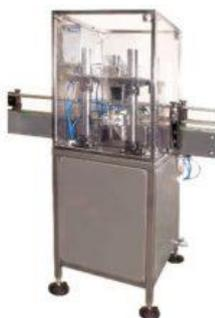
Укупорочная машина роликового типа под нестандартную пробку УА-3000Р предназначена для автоматического укупоривания пластиковых бутылок полиэтиленовыми винтовыми крышками, типа триггер, пуш-пул, твист-офф, спорт-пробками и пр.
