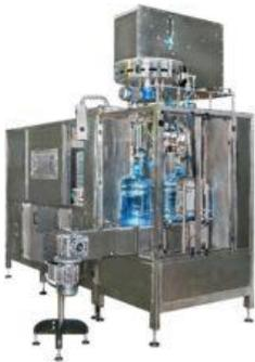
Автоматическая линия типа TP19 предназначена для многоступенчатой мойки, дезинфекции, ополаскивания, а также розлива и укупорки бутылей объемом 18,9 дм<sup>3</sup> (5 галлонов) в автоматическом режиме негазированной питьевой водой.
