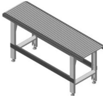
Роликовый рольганг промежуточный – рольганг неприводного типа модульного исполнения используется при комплектации термоупаковочного оборудования для перемещения пакуемых товаров. По ним проходит продукция от оборачивающего узла (термоножа) до термотоннеля.
