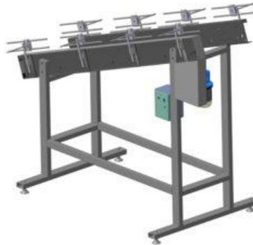
Приводной рольганг МТУ модульного исполнения используется при комплектации термоупаковочных машин. Служит для перемещения самых разнообразных предметов.
