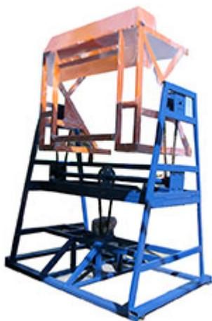
Опрокидыватель контейнеров предназначен для быстрого и аккуратного опрокидывания больших контейнеров с картофелем (луком). Опрокидыватель контейнеров оснащен электромеханическим приводом и спроектирован для продолжительной работы.
