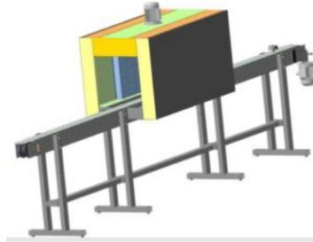
Термотоннель МТУ-117 предназначен для штучной и групповой упаковки рулонов в рукавные этикетки. Тип и характеристики упаковочного материала подбираются в каждом конкретном случае с учетом назначения упаковки, вида, размеров и количества продукции. Термотоннель МТУ-117 представляет собой сборную металлическую конструкцию, включающую следующие элементы:
