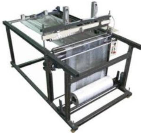
Оборудование для производства полиэтиленовых пакетов имеет модульную комплектацию, которая включает два модуля: модуль Термонож МТУ-266 и модуль Стол. Тип и характеристики материала подбираются в каждом конкретном случае с учетом особенностей изготовления пакетов из полиэтиленовой плёнки.
