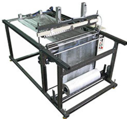
Установка предназначена для изготовления пакетов для мусора и прочего с донным швом из рукава полиэтиленовой пленки.
