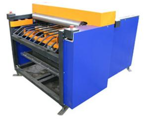
Предназначена для прошивки матов из базальтового микро-, ультра-, супертонких и микрокристалических волокон из горных пород стеклонитью, стеклоровингом и т.п. Для прошивки используется стеклонить (по ТУ6-48-0205002-71-90 изм.1) или стеклоровинг РБФ13-420-76, ЕС 13 630 Н-78(210) и т.п.
