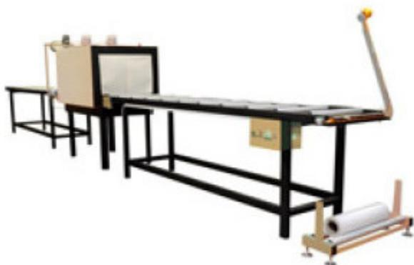
Упаковочная машина МТУ «ЛАРГО элемент» предназначена для упаковки в термоусадочную полиэтиленовую пленку длинномерных и погонажных изделий: вагонки, бруса, половой доски, панелей ПВХ, готовых элементов мебели и т.п.
