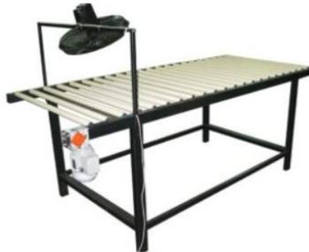
Роликовый конвейер – транспортирующее устройство для разнообразных массовых штучных грузов, перемещаемых по стационарным опорным вращающимся роликам.
