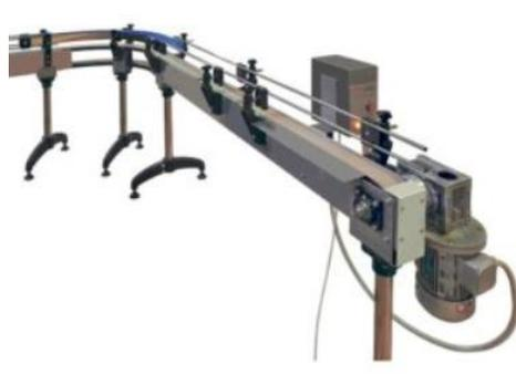
Транспортер узкий ТРП с лентой из нержавеющей стали предназначен для горизонтального перемещения изделий (бутылок, флаконов, канистр, пакетов и другой тары) от оборудования для выдува до автоматов розлива и укупорочных машин.
