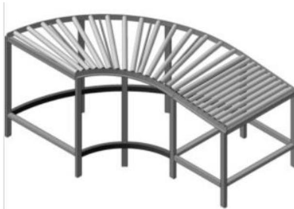
Поворотный конвейер – разновидность роликовых конвейеров. Применяется как связующее звено при перемещения самых разнообразных по весу и размерам штучных и групповых упаковок в технологических процессах термоупаковки. Трасса поворотного конвейера может быть повернута под углом от 30 до 90 градусов. Изготавливается как в приводном, так и неприводном исполнении.
