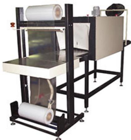
Упаковочная машина МТУ «ИМПУЛЬС-600» предназначена для штучной и групповой упаковки различных видов продукции в полиэтиленовую термоусадочную пленку. В состав машины входят: термотоннель МТУ-112 с движущимся транспортером и одной зоной нагрева, оборачивающий узел с прямым ручным импульсным (три нити) термоножом МТУ-221, подающий и приемный столы. Возможна комплектация по желанию заказчика.
