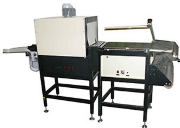
Упаковочная машина МТУ «Импульс-300» предназначена для штучной и групповой упаковки различных видов продукции в поливинилхлоридную (ПВХ) и полиолефиновую термоусадочную пленку (полурукав).
