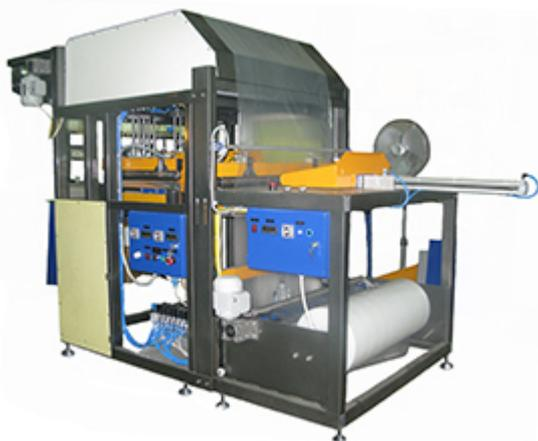
Упаковочная машина МТУ «Гамма» предназначена для групповой упаковки различных видов изделий текстильной промышленности в полиэтиленовую пленку, выпускается в модификации «полуавтомат». В состав машины входят: Пневматический толкатель продукции, автоматические подмотчики пленки, оборачивающий узел, пневматический пресс, термоножи постоянного нагрева для запайки швов.
