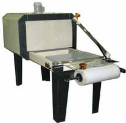
Машина термоупаковочная МТУ «Элемент» предназначен для упаковки различных видов изделий в полиэтиленовую пленку. Тип и характеристики упаковочного материала подбираются в каждом конкретном случае с учетом назначения упаковки, вида, размеров и количества продукции. Для нормальной работы аппарата рекомендуется использовать пленку полиэтиленовую ГОСТ 25951-83, толщиной 60?80 мкм.
