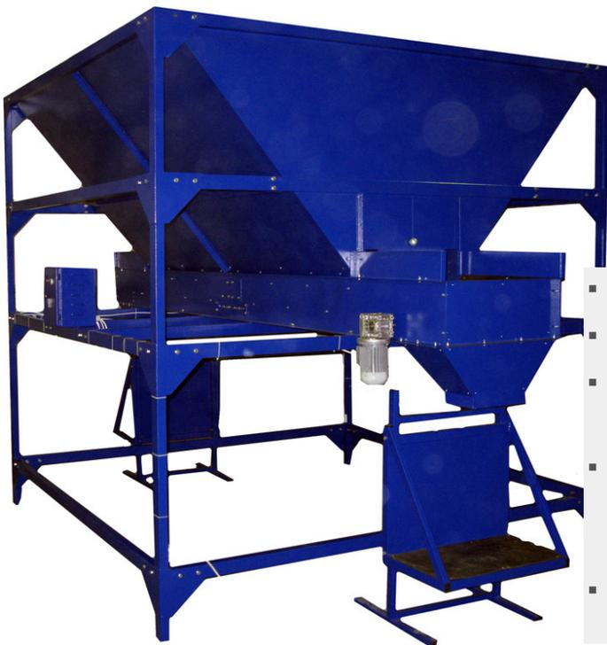
Распределительный бункер предназначен для затаривания картофеля (лука) в сетки.
