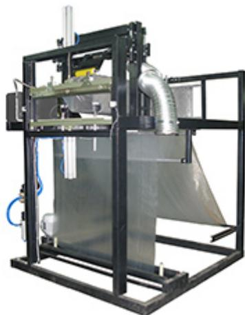
Упаковочная машина МТУ «БЛОК» предназначена для упаковки блоков грибного субстрата в полиэтиленовую термоусадочную пленку (ПЭ) в автоматическом режиме. Тип и характеристики упаковочного материала подбираются в каждом конкретном случае с учетом назначения упаковки, вида, размеров и количества продукции. На оборудование МТУ «БЛОК», возможна упаковка блоков грибного субстрата, только при наличии Пресса-
